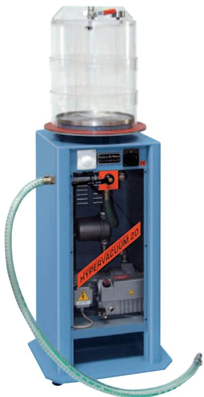
Le caratteristiche costruttive di queste macchine consentono l'impiego continuativo per tutto l'arco della giornata. La disareazione di imperfezioni o bolle incluse nei getti fusi. Il compattamento del rivestimento è favorito da apposita vibrazione automatica del piatto.
