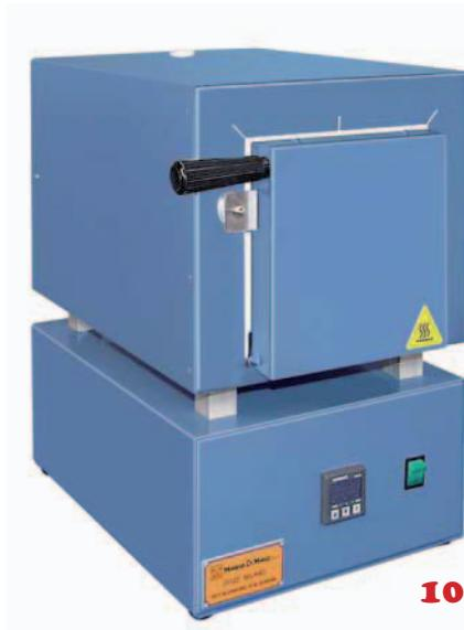
Forno per la ricottura dei cilindri, camera e sportello con elevato isolamento termico e rivestimento esterno in acciaio, resistenze annegate nel refrattario, pirometro automatico elettronico con dispositivo di sicurezza che interrompe la corrente in caso di rottura della termocoppia. Tramite un programmatore elettronico è possibile impostare e visualizzare (su display digitale) la temperatura d'impiego.
