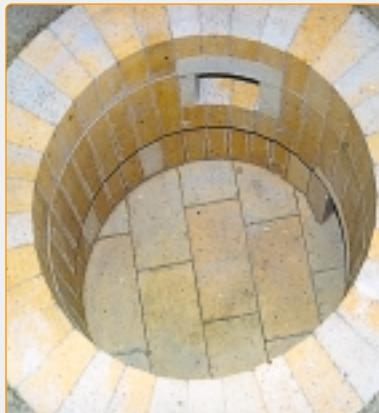
**Forno fusorio per gas liquido (GPL), gas metano o Gasolio (specificare in sede ordine), con ventilazione forzata.** Realizzato in robusta carpenteria metallica, camera crogiolo con coperchio ribaltabile e rivestimento interno in materiale refrattario ad alto contenuto di allumina composto da elementi prefabbricati facilmente sostituibili. Il forno dispone di un crogiolo recuperatore di metallo contro travasi o rottura.
