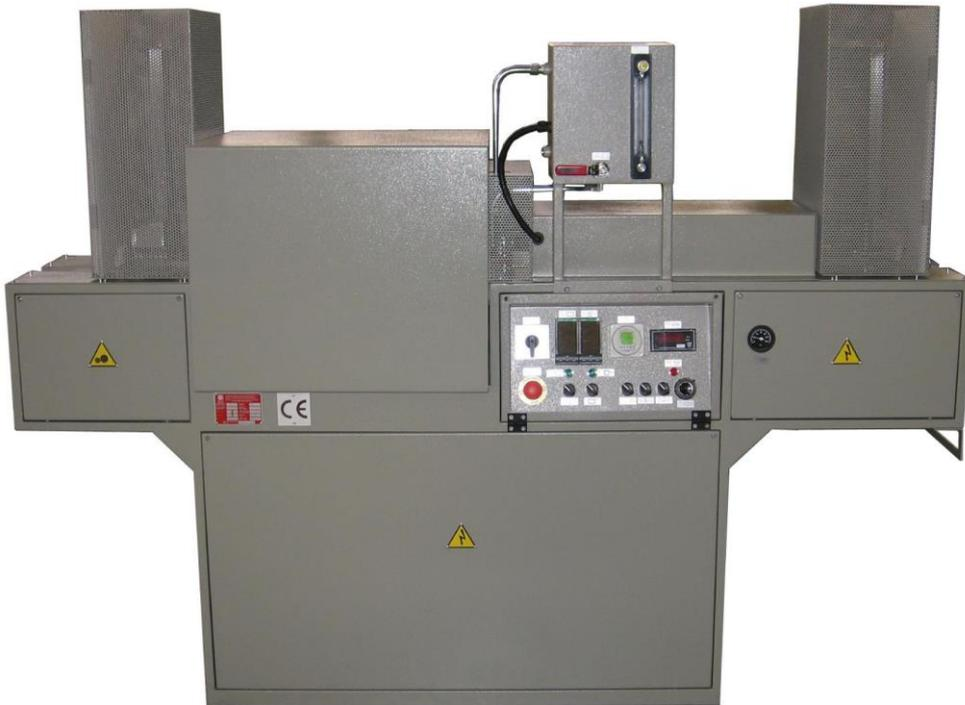
Forno elettrico a nastro trasportatore a singola camera di lavoro avente zona unica di riscaldamento per saldobrasature e trattamenti termici in atmosfera disossidante. Dotato di camera di raffreddamento ad intercapedine d'acqua e quadro elettrico integrato nel forno. Completo di dissociatore di ammoniaca.
