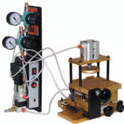
**Alimentatore per matrici in gomma.** Dispositivo automatico pneumatico per il posizionamento e la tenuta delle matrici in gomma durante la fase di iniezione della cera. Indicato per elevato carico di lavoro è da abbinare all'iniettore Vacwax. E' composto da un corpo meccanico di presa matrici e gruppo di regolazione e comando ciclo.
