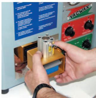
**E203804 - Dispositivo pneumatico per la tenuta delle matrici in gomma durante la fase di iniezione della cera. Indicato per elevati carichi di lavoro. E' composto da una pinza di chiusura matrici con attuatore pneumatico, pulsante di comando e gruppo di regolazione pressione. Richiede alimentazione aria 4 bar, per matrici. Dimensioni: 70 x 70 x 45 (H) mm, peso 0,6 kg.**
