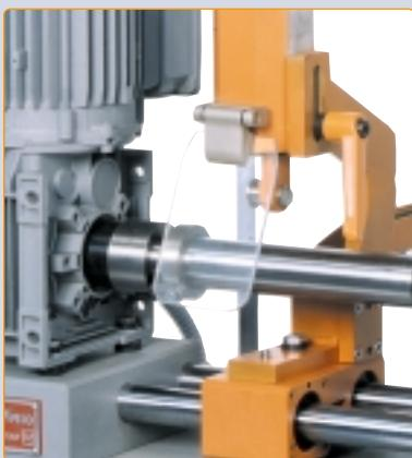
L'avvolgitrice è una macchina progettata per avvolgere tubo e canna saldata (con e senza anima interna), utilizzabili per realizzare bracciali e orecchini di varie dimensioni e geometrie. L'avvolgitrice monta mandrini avvolgitubo con differenti profili (vedi figura). È equipaggiata con una ruota guida-canna comandata da un testa pneumatica a pressione regolabile, che consente la lavorazione della canna garantendo una pressione costante in ogni posizione del profilo.
